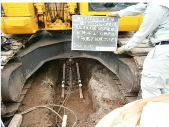
写真-3 平板載荷試験セット完了
