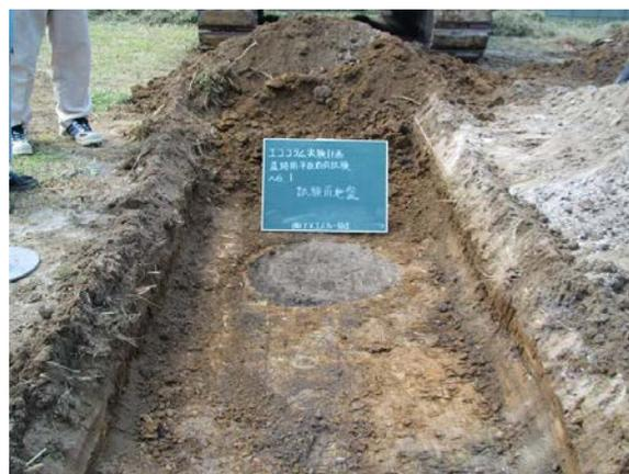
写真-4 平板荷重試験セット前の状況
