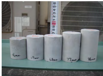
写真 2.2 材齢 7 日時の供試体の状況
