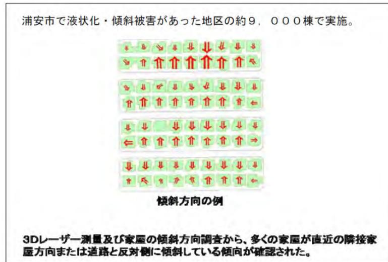
図1.2.3 戸建て住宅の傾斜方向調査
